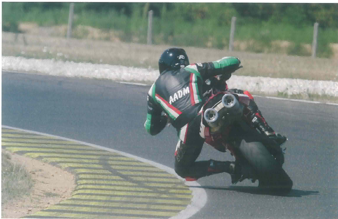
Uno dei principali limiti della Multistrada in pista è costituito dalla scarsa luce a terra.
